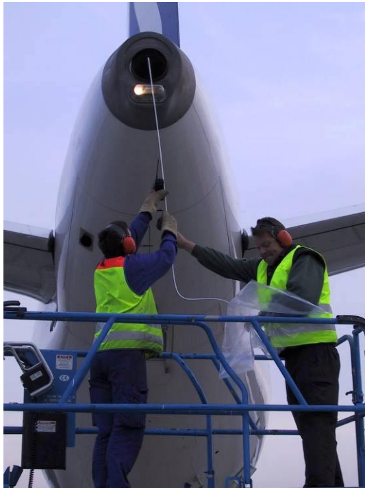
Figur 5. Prøvetagning på APU motor (Honeywell GTCP 131-9A) i Københavns Lufthavn.
