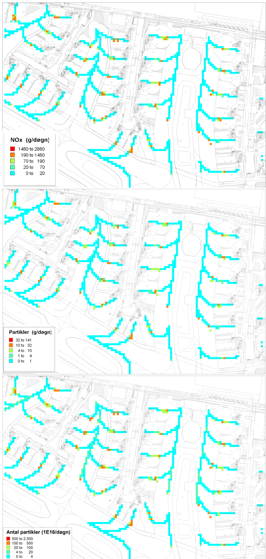
Figur 3.12. Emissioner af NO x og partikler for APU anvendelse i et døgn pr.5x5 m 2 .
