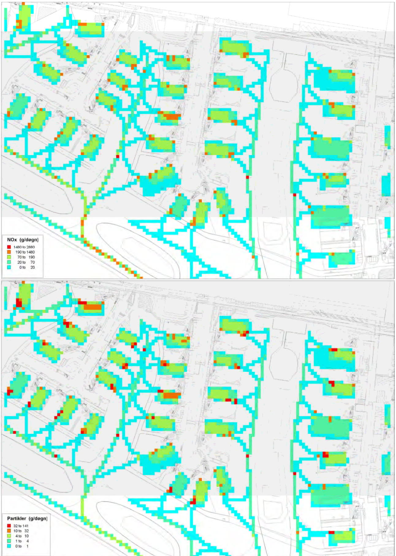
Figur B2.11. Totale emissioner af NO x og partikler for et døgn i forpladsområdet.
