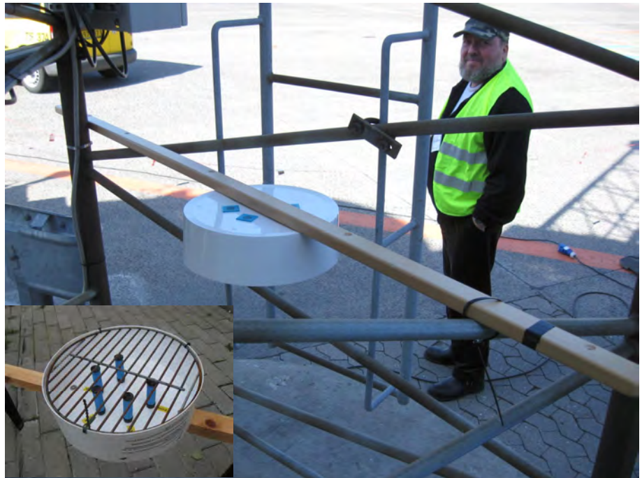
Figur B1.1. Det simple udstyr til opsætning af Radiellorørene til opsamling af benzen og NO 2 . Rørene er placeret nedenunder den hvide spand. Det lille indsatte billede viser, hvordan de seks Radiellorør er monteret i spanden.
