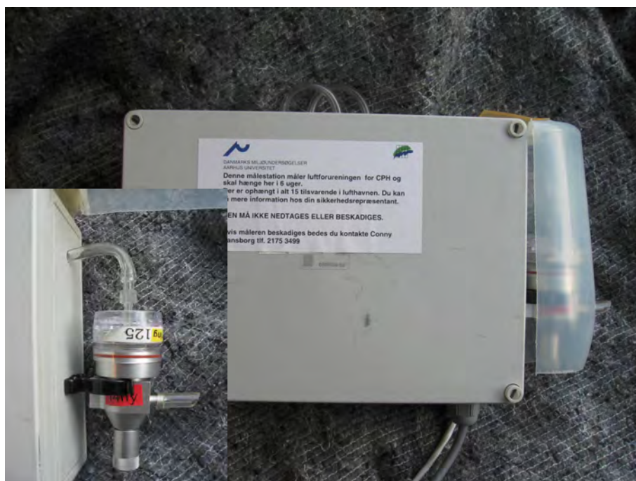
Figur B1.2. Den simple opsamler til bestemmelse af PM_{2.5} . Det indsatte billede viser luftindtaget (det vandrette klare plasticrør), cyklonen (metaldelen) og partikelfilterholderen (plasticholderen med nummeret). Under brugen er cyklon og partikelfilterholderen beskyttet af plastickepper (til højre på det store billede). Pumpen er placeret inde i den grå kasse. Under opsamlingen blev flowhastighed kontrolleret med datalogger, som ligeledes sidder inde i kassen. Opsamleren var forsynet med netspænding.
