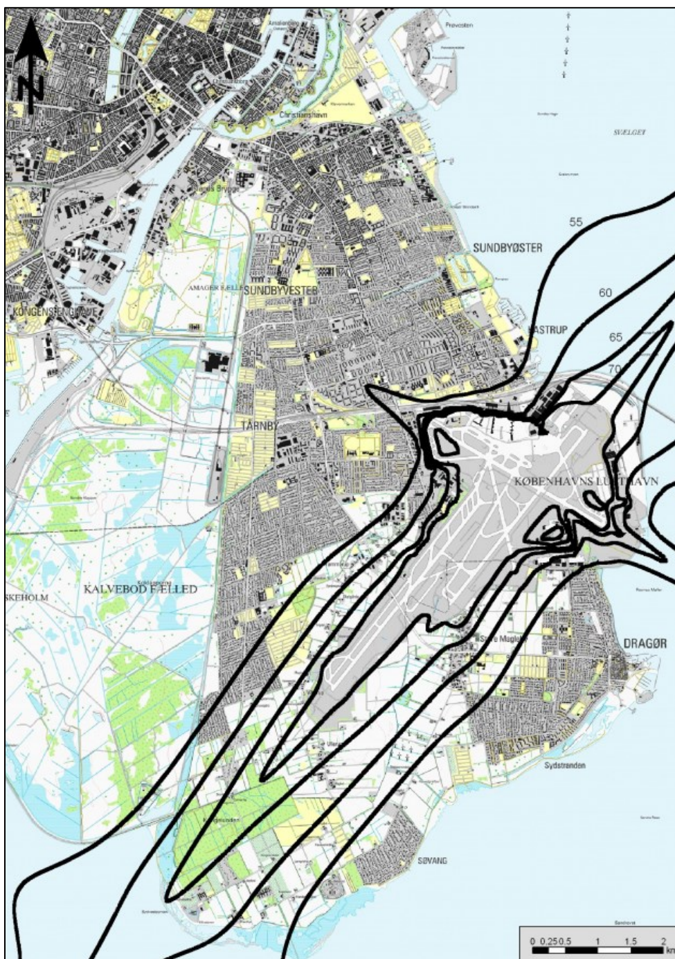
Figur 9: Eksempel på resultat af L_{DEN} beregning scenarie A-N støjkurver fra 55 – 70 dB. (Kilde: 2020-rapport[REF A])
