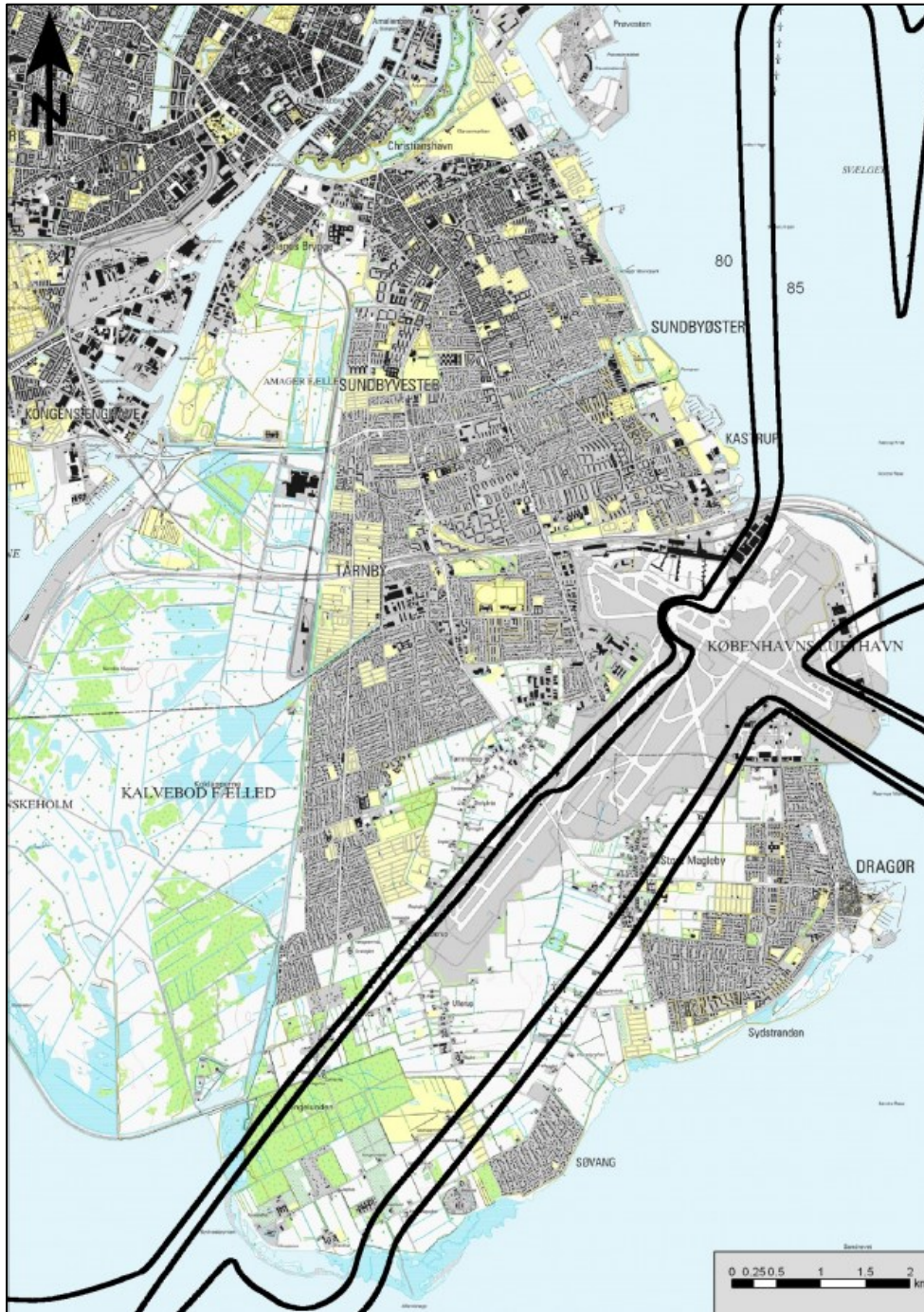
Figur 13: Eksempel på beregningsresultat for L_{Amax} for starter og landinger i natperioden i 2020, 1-N scenariet (Kilde: 2020-rapport [REF A]).
