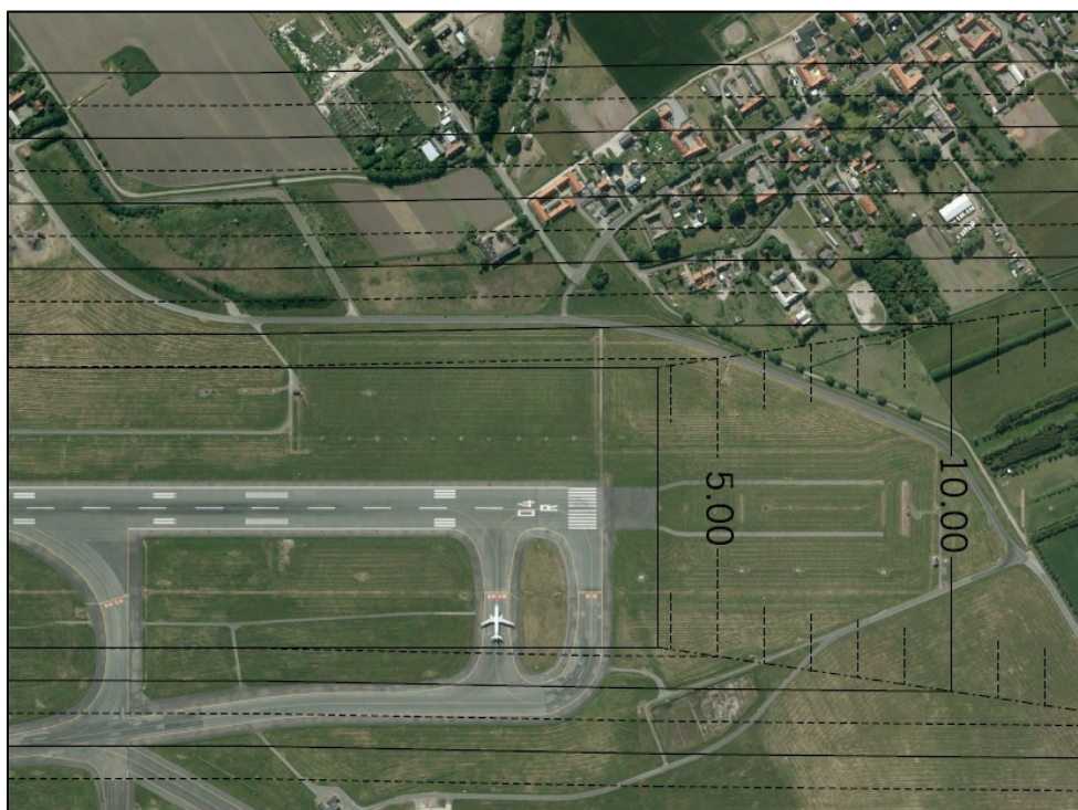
Figur 20: Kort med højderestriktioner omkring 04R. Koterne på højderestriktionskortet er angivet i meter over middelvandstand. Terrænet i skel til St. Magleby er i kote 2,5 – 4,5 m. Dette betyder, at en støjskærm i skel maksimalt kan have en højde på mellem 3-8 m (Kilde: CPH).
