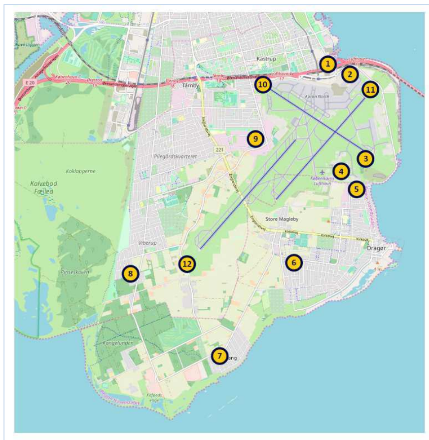
Figur 22: Støjovervågningssystemet består af 12 støjmålestationer.
